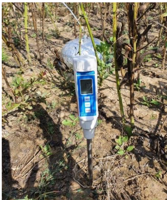
4.5. att. Augsnes mitruma mērītājs un gāzu mērījumu kamera (autora veidots)
